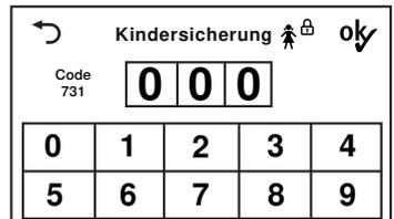
Nach der Entriegelung kann das Gerät normal bedient werden. Die Kindersicherung wird automatisch aktiv, sobald das Programm gestartet wird.
