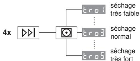
Modifier le degré de séchage, si le linge n'est pas assez sec ou s'il est trop sec. Le nouveau degré de séchage est alors valable pour tous les programmes. Un très léger séchage ultérieur est conseillé pour de l'eau très dure et un séchage ultérieur très fort pour de l'eau très douce.
