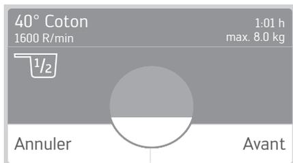
Le poids du linge est mesuré lors du remplissage. Si le poids se situe en dessous de 50 % de la charge maximale, le temps de lavage est diminué.
