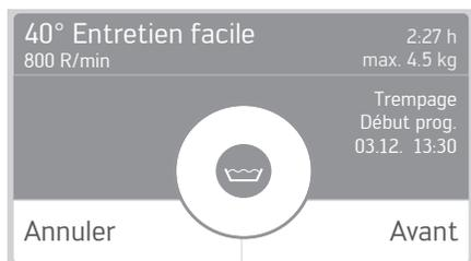
Après écoulement de la durée de trempage, le programme sélectionné se lance automatiquement.
