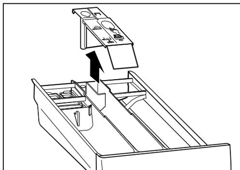
4. Nettoyez compartiments et cloison à cloison à l'eau courante.
