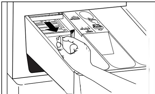
A seconda dei tipi e della quantità di detersivo, è possibile spostare l'inserto della vaschetta **II**.
