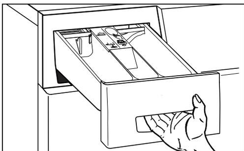
► Estrarre il cassetto per i detersivi fino alla battuta d'arresto. Inserire il detersivo o l'additivo nella vaschetta **I, II** oppure ☼:
