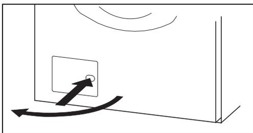
3. Estrarre il tubo di svuotamento, estrarre il tappo di chiusura, lasciar scorrere l'acqua in un contenitore. Se necessario, ripetere più volte l'operazione.
