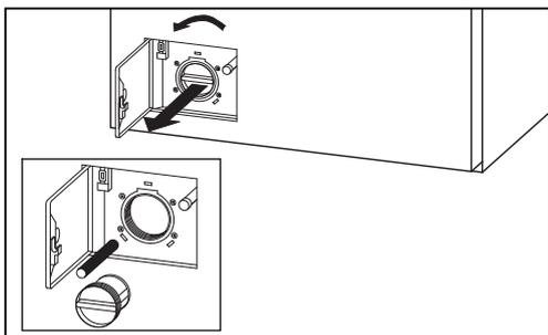
5. Rimuovere i corpi estranei e i residui tessili. Pulire l'interno della pompa. Le alette della pompa devono poter girare liberamente.
