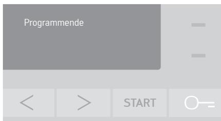
Bei eingeschaltetem Knitterschutz dreht die Trommel bei Programmende in kurzen Abständen weiter (siehe **Einstellungen / Knitterschutz**). Die Tür kann geöffnet werden.
