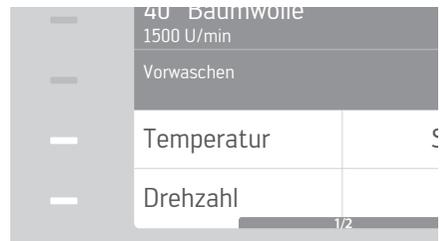
Durch Drücken des Leuchtbalkens bei **Drehzahl** lässt sich die Drehzahl in Schritten von 100 U/min verringern. Bei 0 U/min erfolgt kein Schleudern und die Wäsche kann nass entnommen werden.
