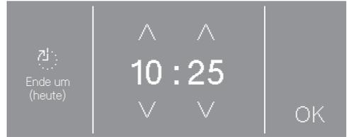
Berühren Sie die Pfeile  $\wedge$  und  $\vee$  und bestätigen Sie mit der Sensortaste **OK**.
